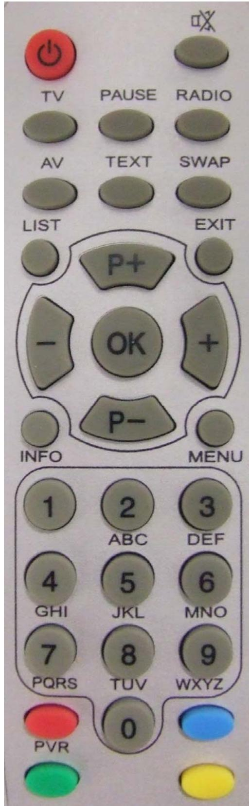
**✖:** Quita la voz (Mute) y función sleep de la instalación (pulsar 3 segundos, produce la desconexión de la instalación SIN plegar la antena)
